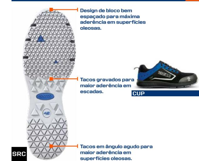
Sola super leve com entressola em EVA e zona inferior em borracha verdadeira com textura PRISMA que permite alta aderência em qualquer condição de flexão do pé.
